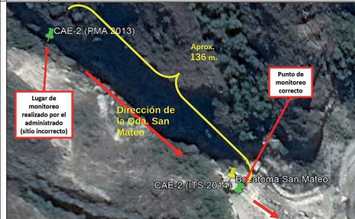
Imagen N° 2: Imagen Google Earth donde se muestra en color verde el punto de Caudal Ecológico aprobado en el PMA 2013 (CAE-2 [PMA 2013]) y el aprobado en el ITS 2014 (CAE-2 [ITS 2014]). Asimismo, se muestra la ubicación de la bocatoma San Mateo en color amarillo. Fuente: Informe de Supervisión (p. 30).
