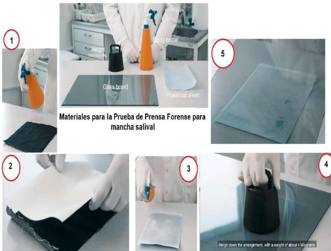
Imagen 4. Preparación de muestra en prensa. 1) Se humedece la muestra con buffer, 2) Colocar encima de la muestra el Papel filtro de prueba, 3) Humedecer el Papel filtro de prueba, 4) Colocar una placa de vidrio y prensar con una pesa de 4 Kg. 5) Retirar la Prensa y observar un viraje a color azul, para un resultado Positivo a la actividad de la Amilasa.
