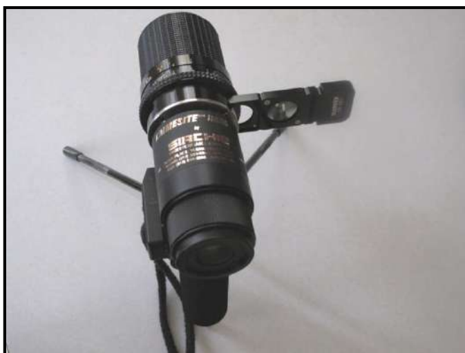
COLOCANDO EL PORTA FILTROS
