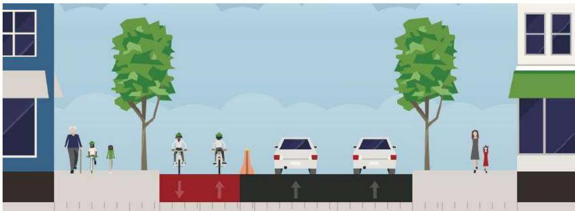
Figura 2. Ejemplos esquemáticos de ciclovías en el lado izquierdo de una vía de un solo sentido.
