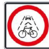
**Circulación compartida.** En ciclosendas o cicloaceras con bajo flujo peatonal (según diseño de la infraestructura). Debe medir 450 x 450 mm. de acuerdo a los parámetros planteados en el Manual de Dispositivos de Control de Tránsito para Calles y Carreteras.
