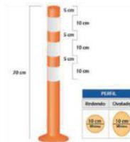
**Delineador compuesto:** Se recomienda su instalación en paralelo a la vía, principalmente para vías colectoras.
