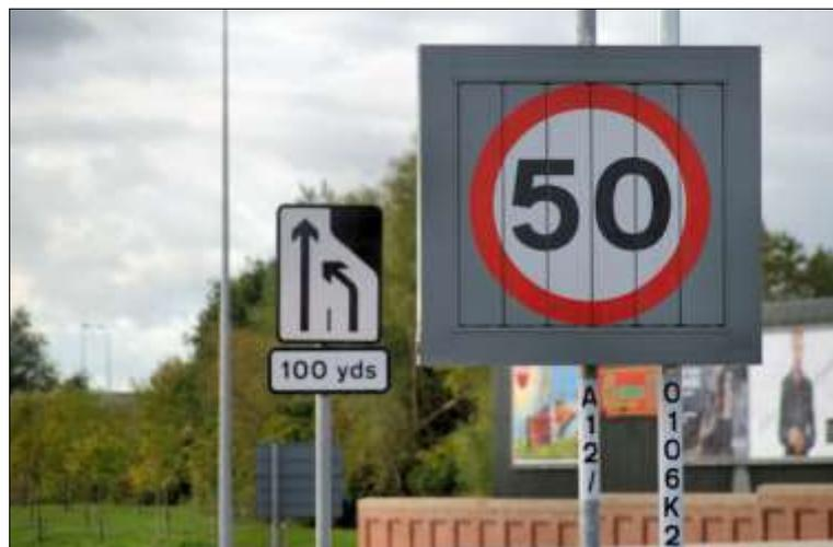
**Figura N°15.35 Señal de velocidad variable electrónica con advertencia intermitente**
