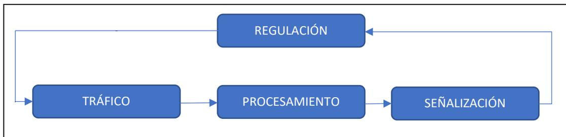
**Figura N°2.3 Arquitectura lógica de los sistemas de gestión de tráfico urbano**
