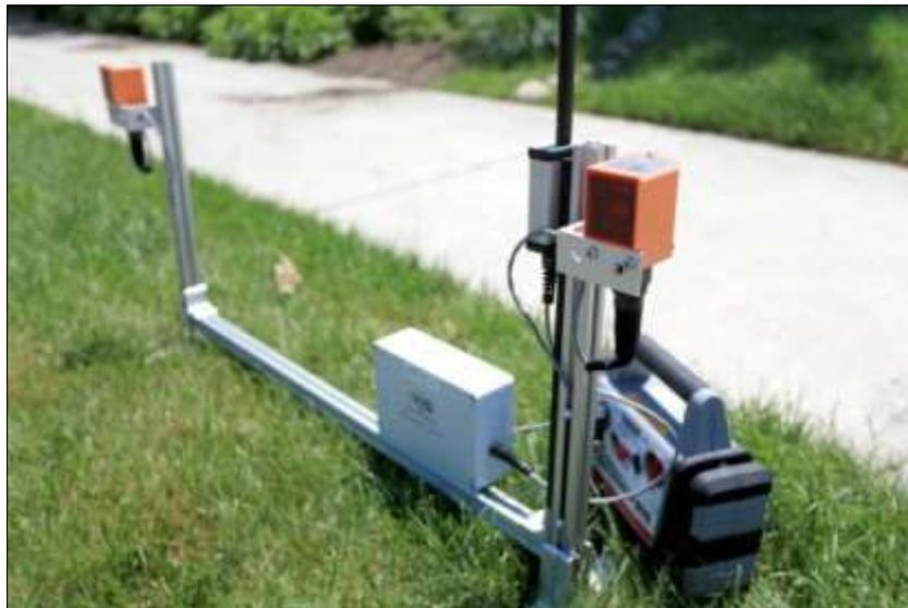
**Figura N°15.15 Ejemplo de RADAR DOPPLER portátil**
