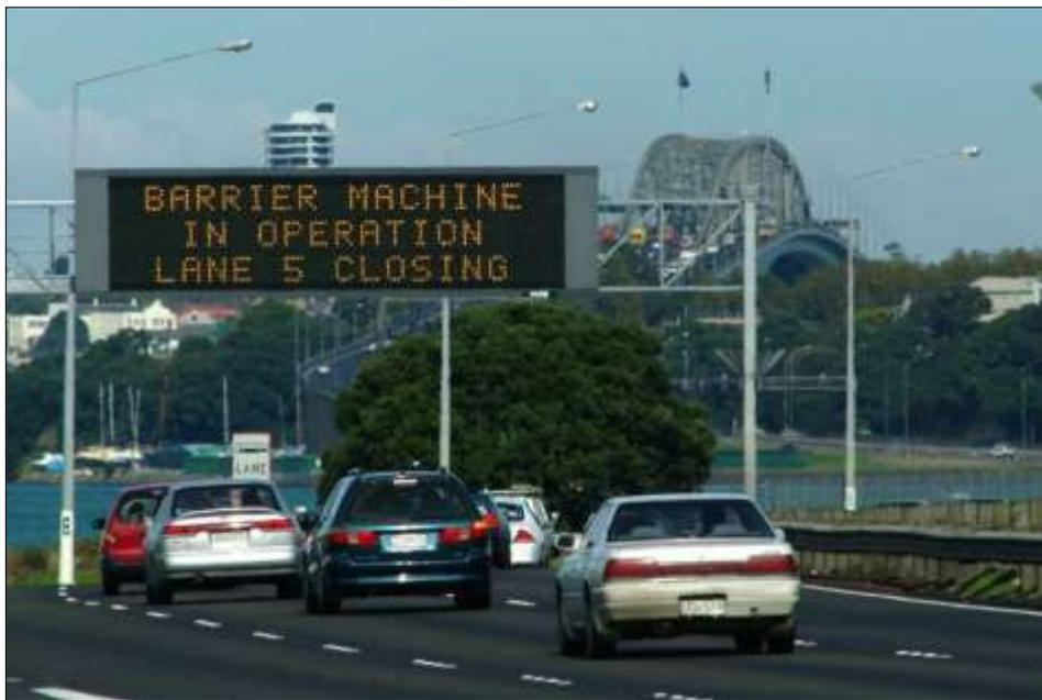
**Figura N°15.31 Ejemplo de panel de mensajería variable fijo alfanumérico con elementos de señalización fija**
